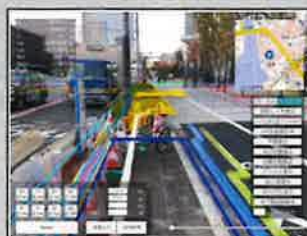
写真2 地下埋設物のAR表示
