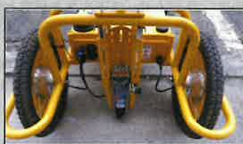
スプレー缶設置状況
