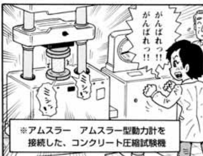
※アムスラー アムスラー型動力計を接続した、コンクリート圧縮試験機
